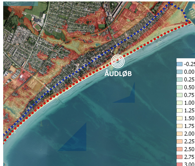
Differentieret sikring - blå linje er en sikring til kote 2,80 m mens rød linje er en sikring til kote 1.54 m. Højvandslukke i Olsbækken.
