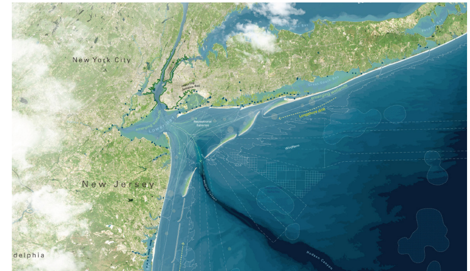
Tegnstuen West 8's forslag til beskyttelse af New York med en kombination af barriere øer og højvandsdiger ( http://www.rebuildbydesign.org/project/wxywest-8-final-proposal/ )
