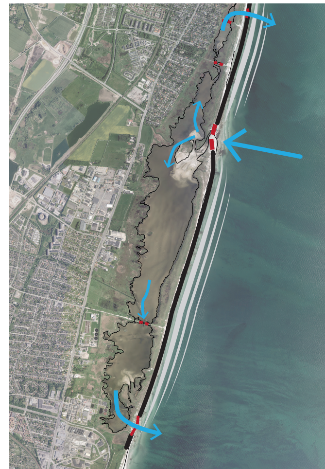
Alternativ sikring i det eksisterende revlesystem.
